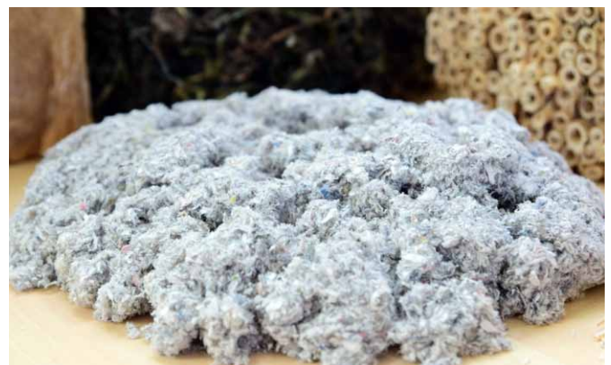
Zelluloseflocken als Einblasdämmstoff
